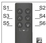
(S1) e (S2) elevam e descem a zona da cabeceira, (S3) e (S4) elevam e descem a zona das pernas. (S5) e (S6) movimentam simultaneamente as zonas da cabeceira e pernas. Apenas com o comando de radiofrequência: Pressione (S5) e (S6) simultaneamente para luz noturna / iluminação debaixo da cama.
